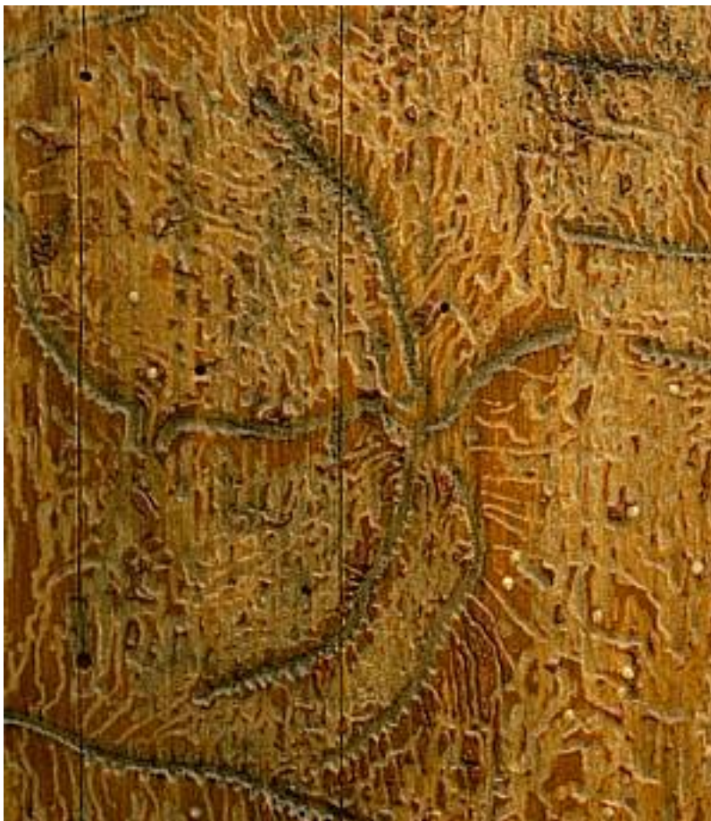
Système de galeries en forme d'étoile, avec berceaux de nymphose encastrés dans l'aubier.
