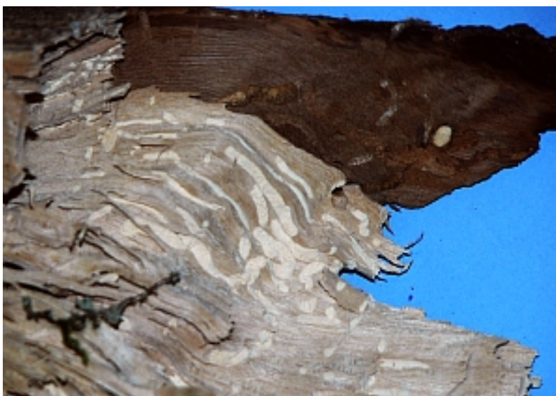
Galleries de nutrition bourrées de vermoulture, évoluant fréquemment le long des fibres du bois.
