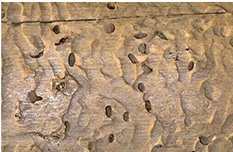
Les galeries de nutrition aux bords tranchants et les galeries en crochet, arrondies qui pénètrent profondément le bois, caractérisent la présence de ce coléoptère.
