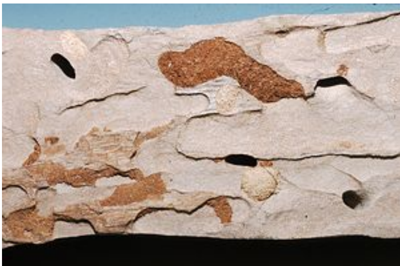
Unregelmässige, teilweise mit Bohrmehl gefüllte Frassgänge der Larven. Sichtbar auch der Beginn der Hakengänge für die Verpuppung (ovale Löcher).
