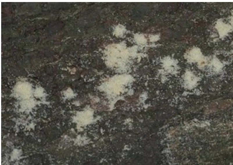
Das viele weisse Bohrmehl deutet auf einen Befall durch den Werftkäfer hin.
