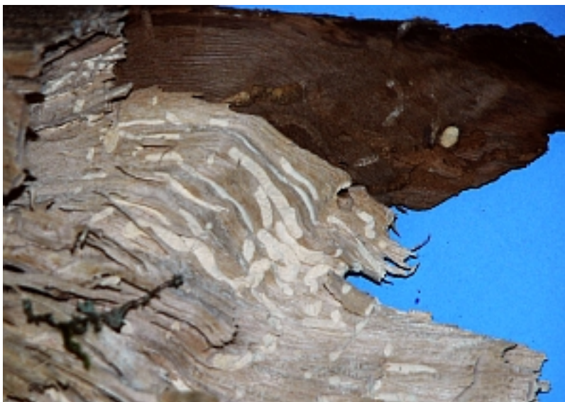
Mit Bohrmehl vollgestopfte Frassgänge im Holz, häufig längs zur Faserrichtung.
